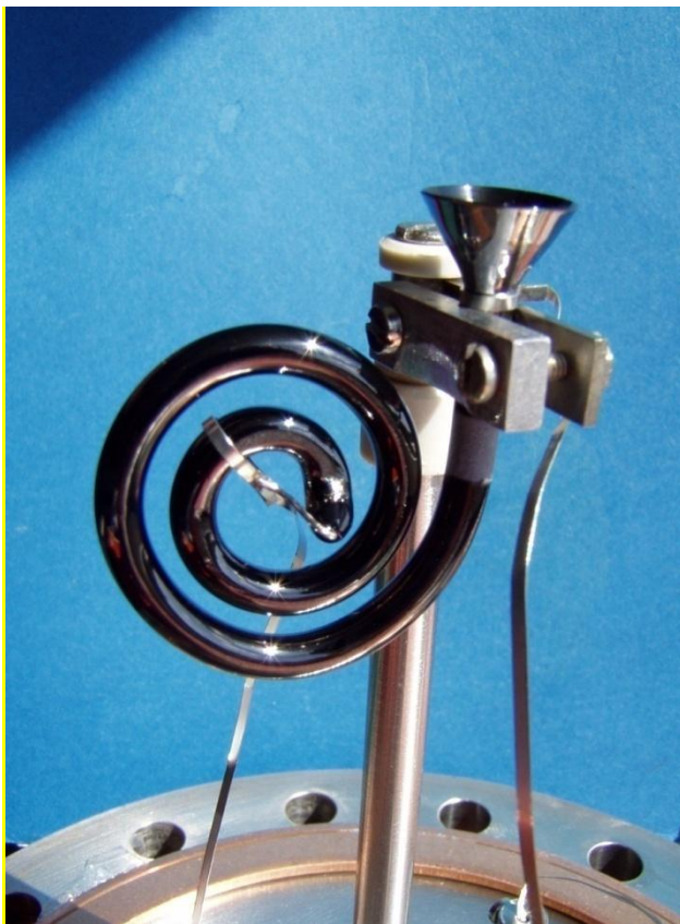
Abbildung 96 reales Channeltron, Perspektive 2
