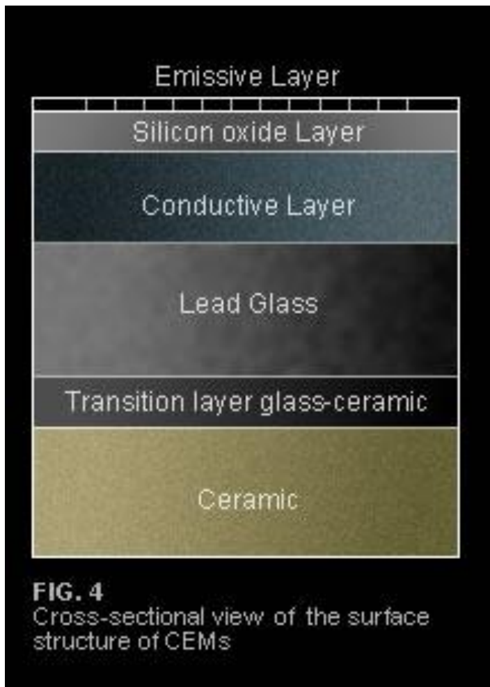
Abbildung 98 Beschichtung des modernen Channeltrons
