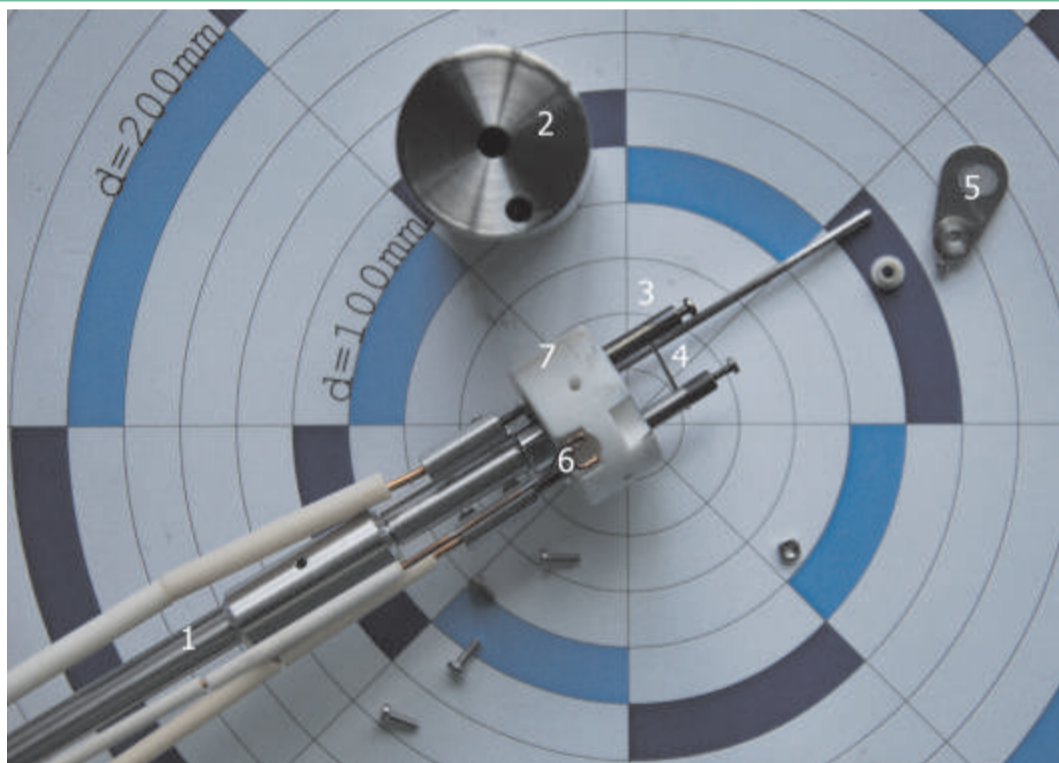
Fig. 1: Kopf des Verdampfers: (1) Stützstab, (2) Hülle, (3) Stromzuführung, (4) Filament ST2/FR wire, (5) Shutter, (6) Fluxstromabnehmer, (7) Keramikplattform, (8) Shutterschalter
